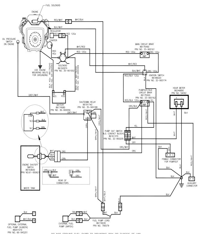
DO NOT GROUND FUEL PUMP TO MOUNTING BOX OR CHASSIS OF VAN USE SUPPLIED FUEL PUMP CORD ONLY
